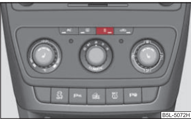
Изобр. 104 Кнопка для непосредственного включения (выключения) независимого дополнительного отопителя и вентиляции на панели управления устройством Climatic
