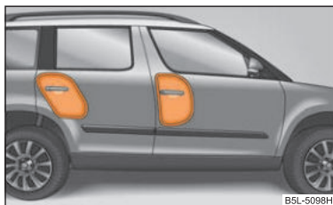
Изобр. 134 Раздутая боковая подушка безопасности, заполненная газом
