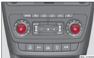
Изобр. 67 Панель приборов: регулятор обогрева передних сидений
