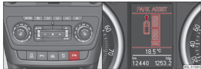
Изобр. 111 Включение ассистента постановки на стоянку / информационный дисплей: поиск подходящего промежутка для постановки на стоянку
