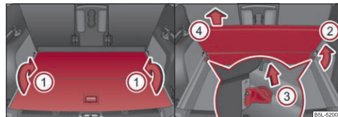
Изобр. 74 Багажник: складывание / извлечение трансформирующегося пола
