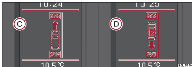
Изобр. 113 Информационный дисплей: указание для включения передачи для движения автомобиля вперед (C) или же заднего хода (D)
