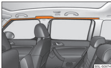
Изобр. 135 Место сборки надувной подушки безопасности Airbag для защиты головы
