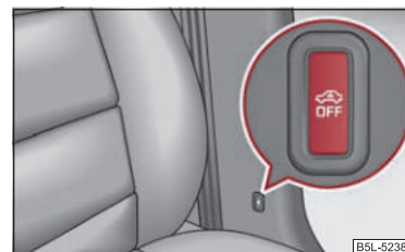
Изобр. 31 Кнопка устройства для наблюдения за внутренним пространством автомобиля и защиты от буксировки автомобиля
