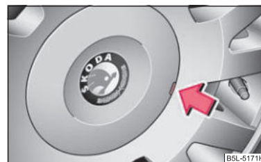
Изобр. 177 Снятие декоративного колпака колес из легкого сплава
