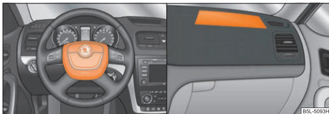
Изобр. 129 Надувная подушка безопасности водителя в рулевом колесе / пассажира переднего сиденья – в панели приборов
