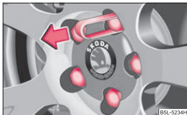
Изобр. 176 Снятие колпака болта крепления колеса
