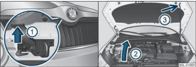
Изобр. 162 Решетка радиатора: Рукоятка фиксатора / фиксация капота двигателя опорой
