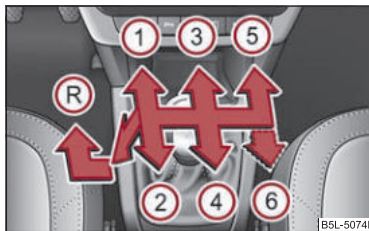
Изобр. 107 Схема переключения передач: пяти- или же шестиступенчатой коробки передач
