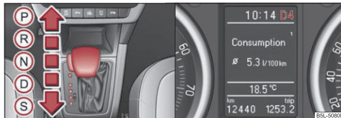
Изобр. 115 Рычаг механизма предварительного выбора передач / Информационный дисплей: Положения рычага механизма предварительного выбора передач
