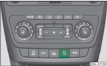
Изобр. 148 Выключатель для настройки опорного значения для контроля давления воздуха в шинах
