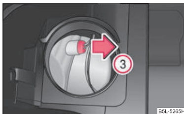
Изобр. 190 Извлечение патрона ксеноновой лампы габаритного фонаря
