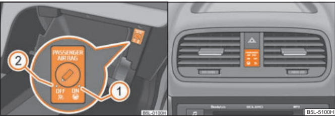
Изобр. 137 Вещевой бокс: Выключатель для передней надувной подушки безопасности для пассажира переднего сиденья / сигнализатора выключенной надувной подушки безопасности для пассажира переднего сиденья
